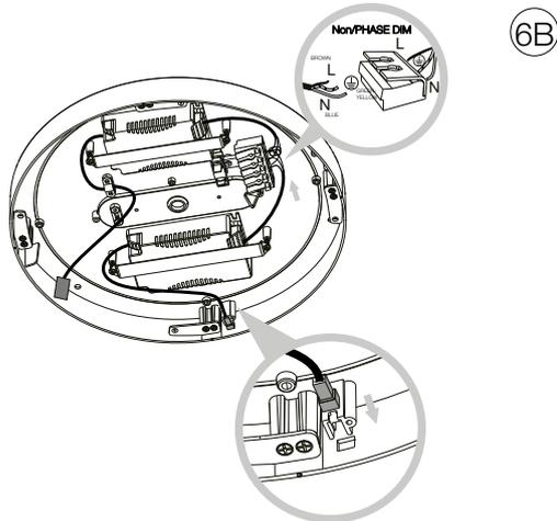
Collegare i cavi alla morsetteria a cinque poli in caso di installazione del modulo UpLight.
