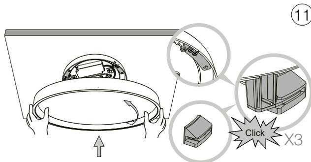
Agganciare il corpo luce alla base montata a soffitto eseguendo una rotazione. Attenzione! Assicurarsi che le staffe laterali combacino e di udire un sonoro Click! (x3 volte) affinché il corpo luce sia effettivamente bloccato. Hook the light source to the mounted base by rotating it. Warning! Make sure the side brackets match and hear a loud Click! (x3 times). The light source will be effectively blocked.
