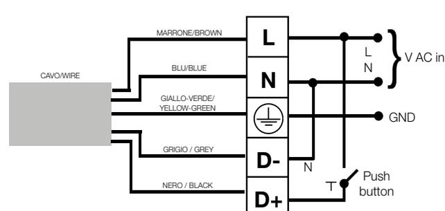
Cablare la morsettiera con il cavo di sospensione fornito seguendo uno degli schemi sopra riportati a seconda de driver scelto.
