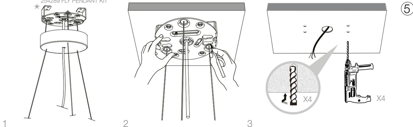
Aprire il rosone. Assicurarsi di rilevare correttamente la misurazione dei fori da praticare affinché sia centrato il proprio punto luce. In caso di base cementizia procedere forando il soffitto; in caso di base lignea saltare il passaggio (3).
