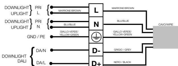
Cablare la morsetteria seguendo uno degli schemi sopra riportati a seconda del driver scelto. Attenzione! Riferirsi a personale specializzato per svolgere l'operazione.
